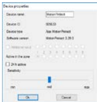
Abb 5. Über das Menü mit den Sensor-Eigenschaften kann der Sensor in der Zone registriert werden
